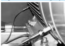
Lagerüberwachung durch Stoßimpulsmessung auf Anfrage.
