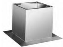
Hoher Flachdachsockel für Entrauchungs-Dachventilatoren aus Stahlblech beschichtet, mit Wärmeisolation und Innenverkleidung aus verzinktem Lochblech, zugelassen für 600 °C, 120 min.
