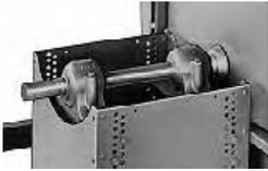
Pendelkugellager mit Spannhülsenbefestigung, schweres Steh-Gussgehäuse auf stabiler Lagerkonsole befestigt.
