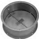
Mechanische Verschlussklappen für Entrauchungs-Dachventilatoren wirken bei Stillstand des Ventilators als Rückschlagklappe und verhindern ungewollten Kaltlufteinfall. Eine Federmechanik schließt die Klappen bei Stillstand des Ventilators.
