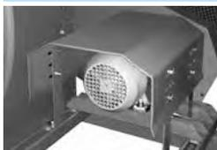
Bei Außenaufstellung des Ventilators muß der Motor mit einem Schuttdach gegen Witterungseinflüsse geschützt werden.
