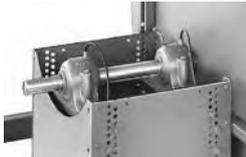
Die Lager sind mit alterungsbeständigem Hochleistungsfett gefüllt. Eine Nachschmierung ist über nach außen geführte Schmierleitungen mit Kegelschmiernippel möglich.
