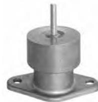
Feder-Schwingungsdämpfer mit Körperschalleinlage und Höhenverstellung, für Drehzahlen über 400 1/min zur Schwingungs- und Körperschallisolierung. Zuordnung der Schwingungsdämpfer zu den Ventilatorarten siehe Preisliste. Die Schwingungsdämpfer werden grundsätzlich mit dem passenden Befestigungsmaterial für den entsprechenden Grundrahmen geliefert.
