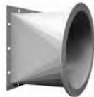
Übergangsstück (eckig/rund) zur Anpassung an unterschiedliche Leitungsquerschnitte, aus Stahlblech geschweißt und beschichtet, zugelassen für 600 °C - 120 min. und zertifiziert.
