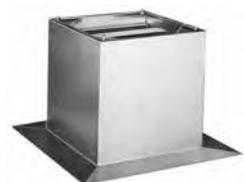
Sockelschalldämpfer für eintrittsseitige Schalldämpfung sind aus beschichtetem Stahlblech gefertigt. Alle Kulissen sind mit verzinktem Lochblech verkleidet, der Zwischenraum ist mit nicht brennbarem, akustisch wirksamem Material gefüllt. ZDS ..-0040 und ZDS ..-0056 mit herausnehmbaren Kulissen.
