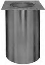
Der rohrartige Eintrittsschalldämpfer besitzt auf der dem Dachventilator zugewandten Seite einen quadratischen Flansch, passend zur Befestigung auf dem entsprechenden Flachdachsockel. Er taucht in den Flachdachsockel ein und an das untere Ende kann dann entweder eine weiterführende Rohrleitung oder eine Einströmdüse montiert werden.
