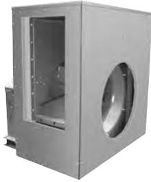
Tragendes Rahmengestell aus Vierkantrrohr geschweißt und beschichtet. Isoliergehäuse für leichte Montier- und Demontierbarkeit in Modulbauweise aufgebaut. Zur Isolierung werden hitzebeständige Kalziumsilikatplatten (Monolux 500) verwendet, diese sind auf der Außenseite mit verzinktem Stahlblech verkleidet. Das gesamte Isoliergehäuse mit stabiler Grundplatte ist mit dem Ventilator-Grundrahmen verschraubt.
