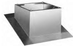
Schrägdachsockel für Entrauchungs-Dachventilatoren aus Aluminium mit Wärmeisolation und selbsttragende Innenverkleidung aus beschichtetem Stahlblech, lieferbar in 5 Grad-Abstufung bis 45° Dachneigung.
